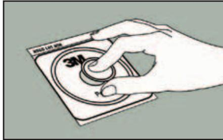
**11** Presione **suavemente** el dispensador para distribuir el inóculo sobre el área circular, antes de que solidifique el gel. **No gire ni deslice** el dispensador.
