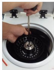
Werkzeug für Rotor ohne Mutter
