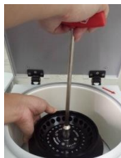
Werkzeug für Rotor mit Mutter
