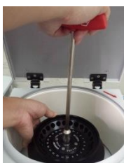
Outil du rotor avec écrou
