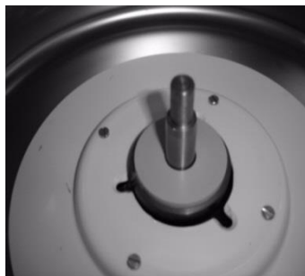
Motorwelle und Kammer
