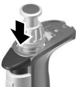
f. 重新将调整滑阀完全向后推，将体积调节轮下压，并松开调整滑阀。贴上标记膜，重新安装标记窗口。
