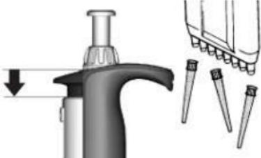
将移液器杆保持在适用废弃处理容器上方，将移液器吸头排放按键向下压至止挡位置。
