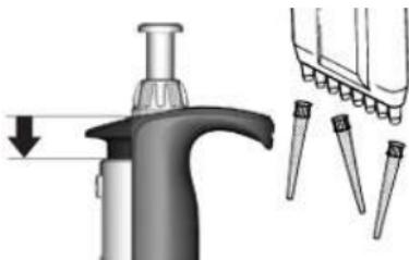
Pipettenschaft über einen geeigneten Entsorgungsbehälter halten und die Spitzentasten bis zum Anschlag niederdücken.
