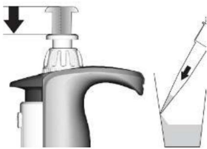
a. 将移液器吸头靠住容器壁。将移液器保持在与容器壁呈 30 – 45° 角度的位置上。
