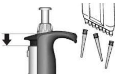
Sujete el vástago de la pipeta sobre un contenedor de desechos adecuado y pulse la tecla de expulsión hasta el tope.
