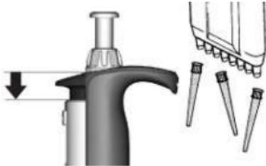
Tenir le corps de la pipette au-dessus d'un collecteur de déchets approprié puis enfoncez la touche d'éjection de la pointe jusqu'à la butée.
